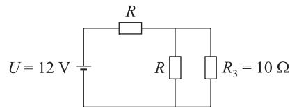
Rješenje. Kako struja  $I_3 = 0.2 \text{ A}$  teče kroz otpornik  $R_3 = 10 \Omega$  daje napon  $U_3 = I_3 R_3 = 2 \text{ V}$ . Tada su naponi na otpornicima  $R$  redom  $10 \text{ V}$  i  $2 \text{ V}$ , pa kroz gornji otpornik teče pet puta jača struja nego kroz drugi. Imamo dakle:
