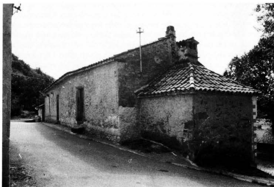
Fig. 14 - Casa di tipo 2B, con vano del focolare rettangolare sulla facciata laterale (Lucchini/Lukini, Pingvente).
