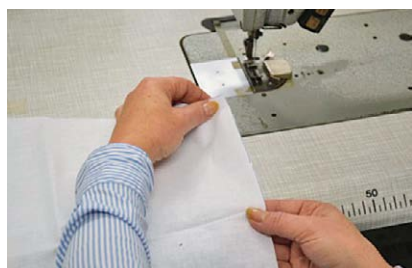
Sl.10 Prikaz slijeda pokreta pozicioniranja izratka korištenjem pomoćne naprave - graničnika
