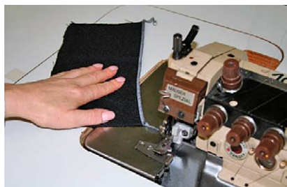
Sl.12 Prikaz slijeda pokreta odsijecanje konca napravom za odsijecanje konca
