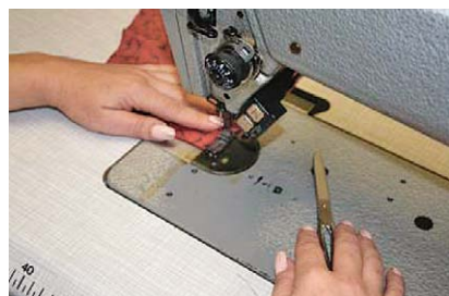
Sl.11 Prikaz slijeda pokreta odsijecanja konca običnim škarama
