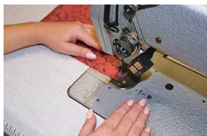
Sl.16 Prikaz slijeda pokreta zakretanja izratka oko igle jednom rukom
