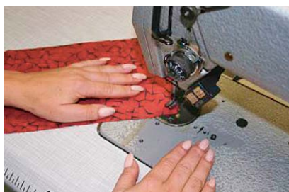
Sl.16 Prikaz slijeda pokreta zakretanja izratka oko igle jednom rukom
