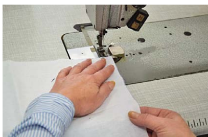
Sl.10 Prikaz slijeda pokreta pozicioniranja izratka korištenjem pomoćne naprave - graničnika
