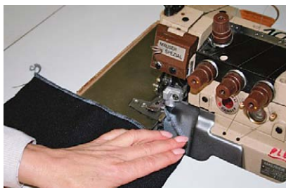
Sl.12 Prikaz slijeda pokreta odsijecanje konca napravom za odsijecanje konca
