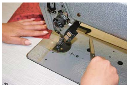
Sl.11 Prikaz slijeda pokreta odsijecanja konca običnim škarama
