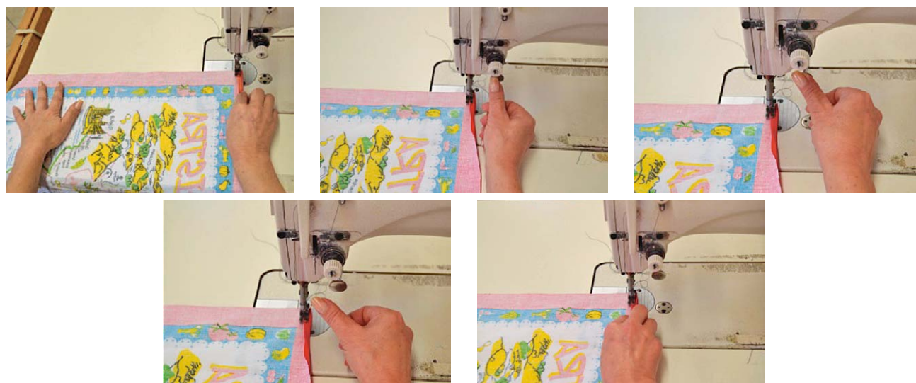
Sl.9 Prikaz slijeda pokreta učvršćivanja šava tipkom za učvršćivanje
