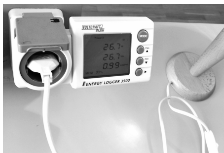
Slika 6. Mjerilo snage. Priključena žarulja je troši 26.7 W.
