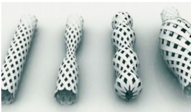
Sl.8 Promjene promjera kod 4D tiskanih cijevi [13]
