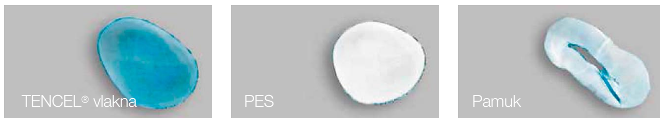
Sl.6 Apsorpcija vlage kod LENZING™ liocelnih vlakana, u usporedbi s PES i pamukom
