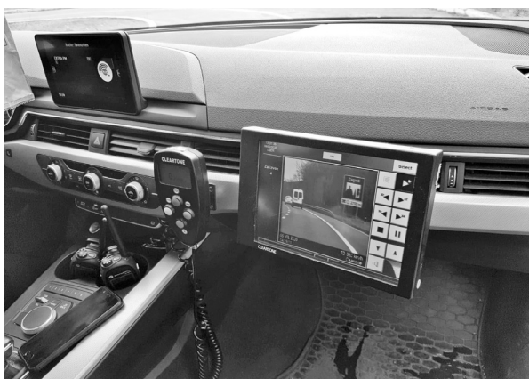
Slika 2: Civilno vozilo, tzv. presretač iz kojeg se mjerila brzina u pokretu
