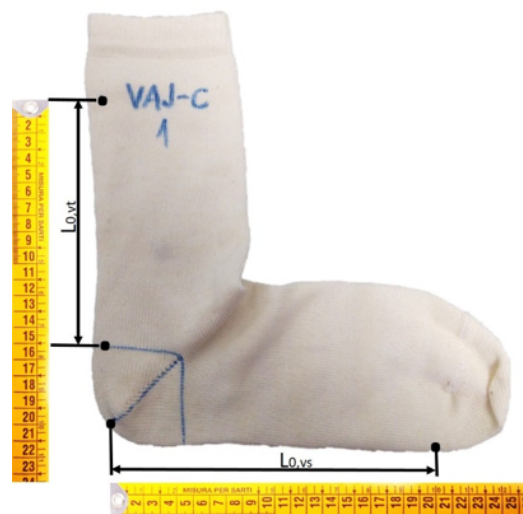
Sl. 4 Obilježavanje uzorka za mjerenje geometrijskih parametara neistegnute čarape
