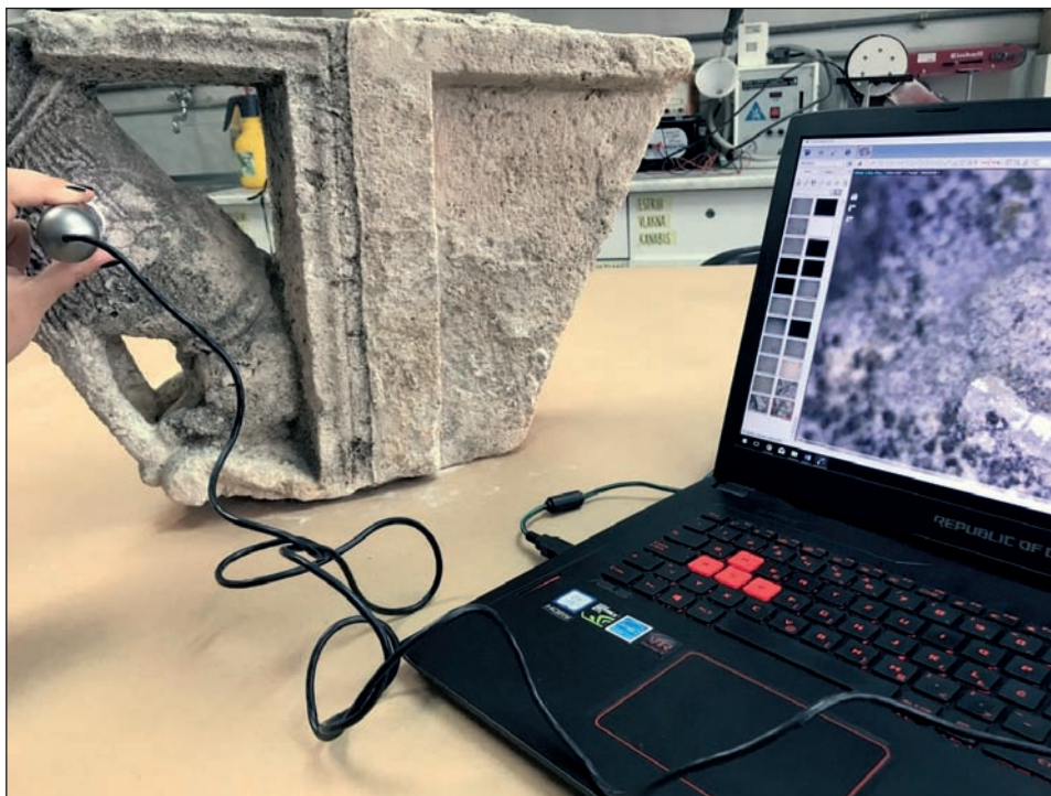
Slika 9. Snimanje strukture kamena mikroskopom Dino Lite (fotografirala Ivana Duvnjak)
