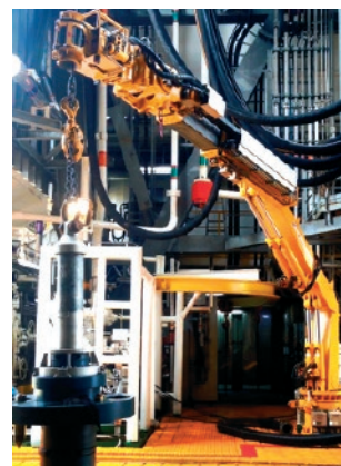
Slika 2-6. Ruka za rad s različitim alatkama na podištu tornja UHT 1 200 kompanije NOV (URL 13)
