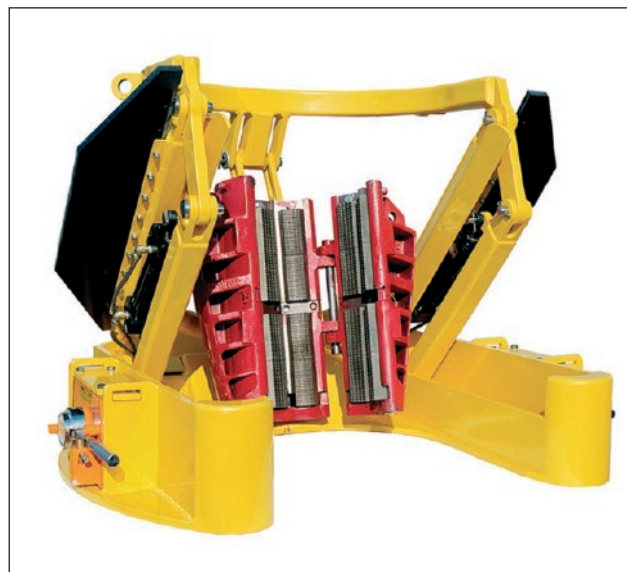
Slika 2-10. Sustav automatskih hidrauličkih klinova s okvirom (URL 17)
