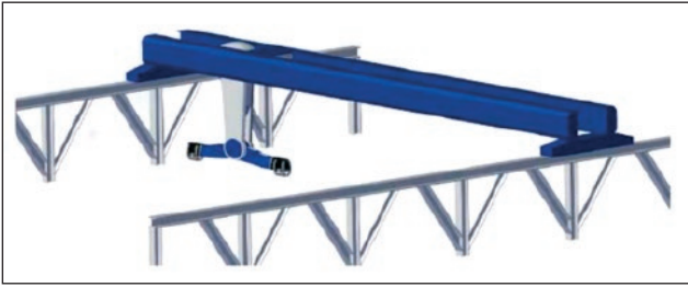
Slika 3-4. Robotizirani sustav rad s cijevnim alatom na odlagalištu cijevnog alata, model PDH - 3 500 (Cappuccio i drugi., 2019.)
