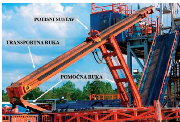
Slika 2-2. Automatizirani sustav za uvlačenje s podizanjem s dvije pomoćne ruke (URL 8)
