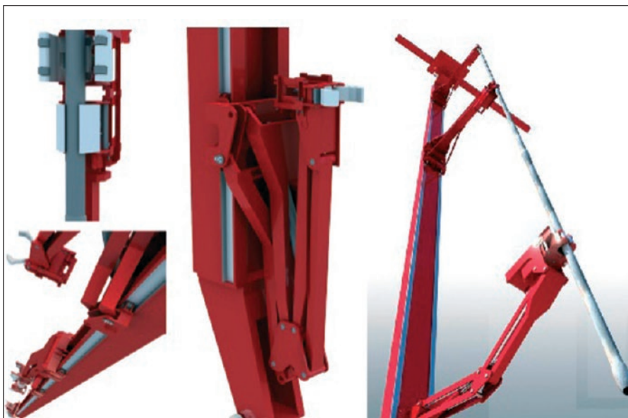
Slika 2-7. Sustav za rad s cijevnim alatkama u vertikalnom položaju kompanije Aker Solutions (URL 12)
