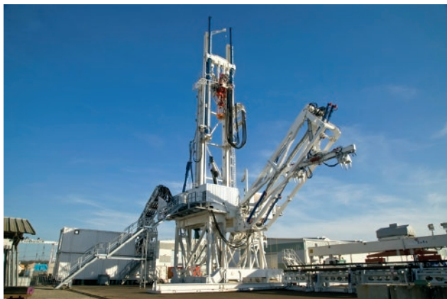
Slika 2-3. Automatizirani sustav s mehaničkom rukom Terra Invader 350 tvrtke Herrenknecht (URL 9)
