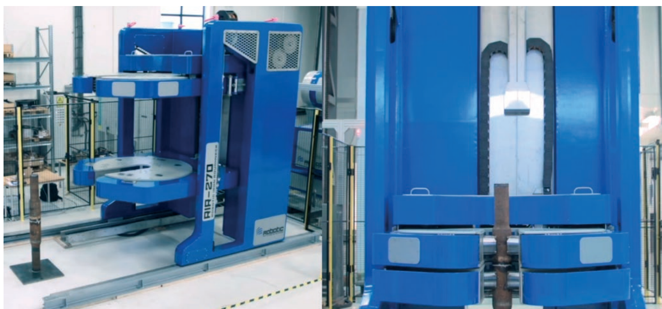
Slika 3-3. Robotizirani hidraulički sustav za navrtanje/odvrtanje cijevnih alatki, model RRN - 270 (URL 24)
