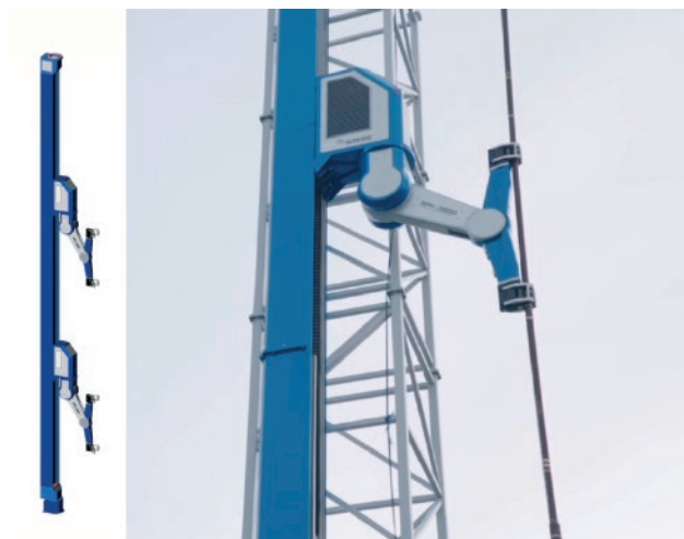
Slika 3-2. Robotizirani sustav za rad s alatima u vertikalnom položaju, model RPH - 7 000 (URL 23 i URL 24)
