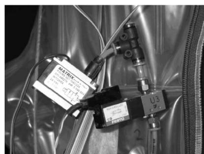
Sl.18 Elektromagnetski ventili za upuh i ispuh komprimiranog zraka u termoizolacijske komore s dijelom zrakovodnog sustava i T-utičnim spojem
