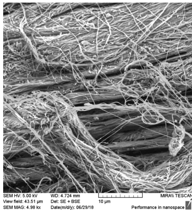
Slika 4: Morfologija površine lica (a,b) i mesne strane (c,d) uzorka VK2 pri različitim povećanju : a,c - 1000x; b,d - 5000x
