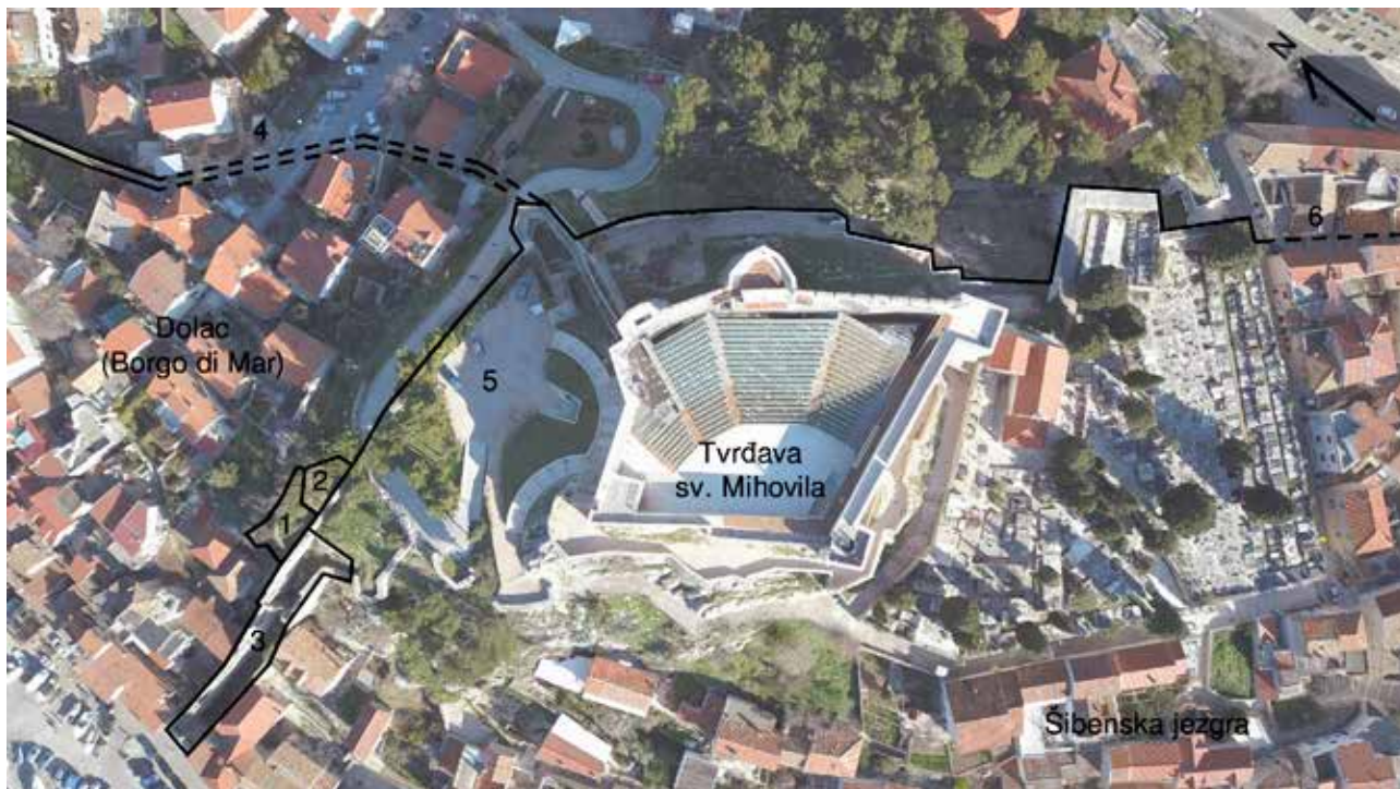
1 Tvrdava sv. Mihovila i dio okolnih fortifikacijskih elemenata: 1 – sperone , 2 – poligonalna kula, 3 – dvostruki bedem, 4 – dolački bedem, 5 – SZ podzid, 6 – gradski bedemi (foto: A. Nakić, 2018., obrada: I. Petković Pavić, 2019.)
