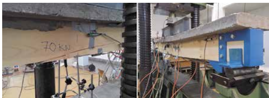
Slika 13. Ispitani nosači, spregnuti (SG2) i spregnuto-prednapeti (PSG1)
