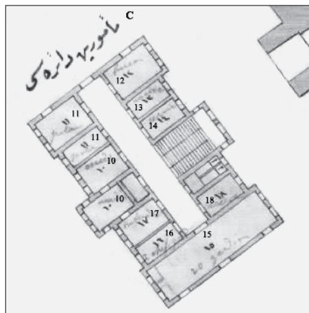
FIG. 14 ADMINISTRATIVE BUILDING SECOND FLOOR PLAN: C – UREDI, 10 – PROSTORIJA ZA UPRAVITELJA ZATVORA, 11 – PROSTORIJA ZA POLICIJSKOG SLUŽBENIKA, 12 – TAJNISTVO, 13 – PROSTORIJA ZA LIJEČNIKA, 14 – PORTIRNICA, 15 – PROSTORIJA ZA 20 ČUVARA, 16 – PROSTORIJA ZA 2 GLAVNA ČUVARA, 17 – PROSTORIJA ZA POSLUŽITELJA, 18 – PROSTORIJA ZA PRITVOR
