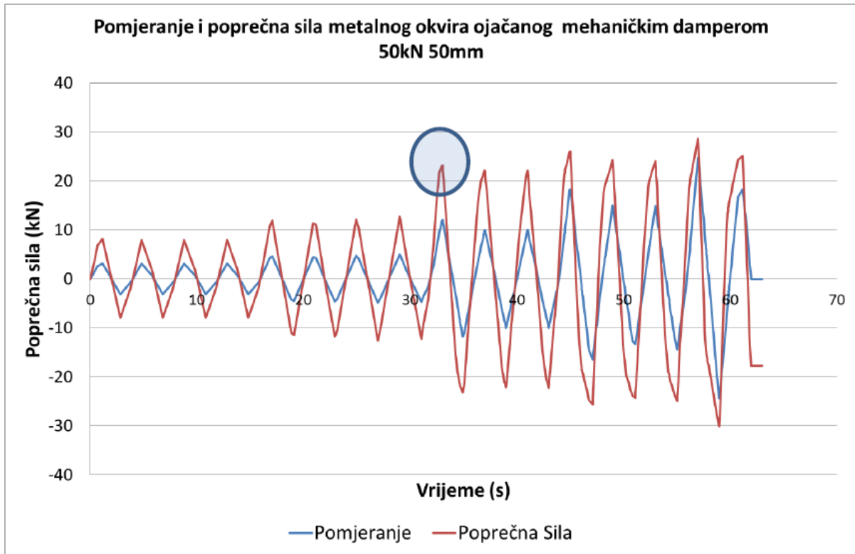
Slika 14. Poprečna sila i pomjeranje metalnog okvira ojačanog mehaničkim damperom MD 50kN 50mm u funkciji vremena
