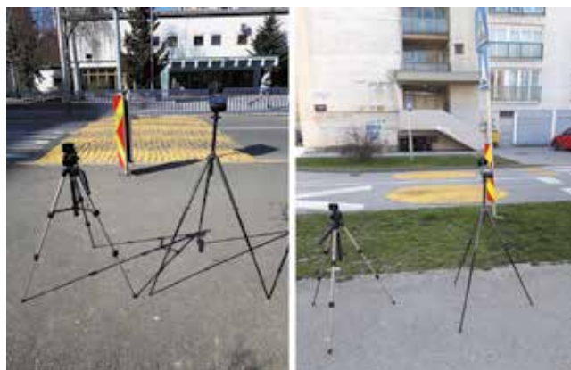
Slika 4. Zvukomjeri i kamere u presjecima u kojima se nalazila oprema za smirivanje prometa
