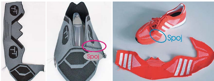
Sl.7 Razni oblici po kroju pletenih gornjišta sa ravnopletaćih strojeva tvrtke Stoll, Reutlingen, Njemačka; gornjište se spaja šavom s bočne strane obuće
