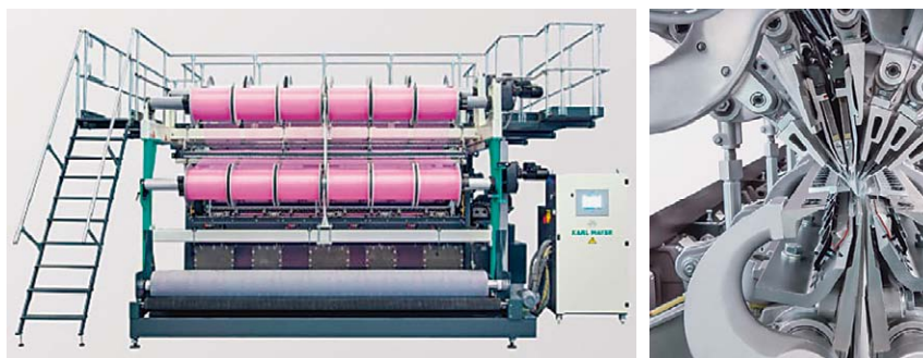
Sl.9 Osnovoprepletaći dvoiglenični stroj model RD 5/1 EL tvrtke Karl Mayer, Njemačka za izradu pletenih gornjišta obuće: a) stroj sa osnovom, b) položaj iglenica i polagala
