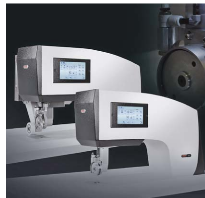
Sl.2 Novi stroj PFAFF 8311 izložen na Texprocess - generaciju strojeva za ultrazvučno spajanje
