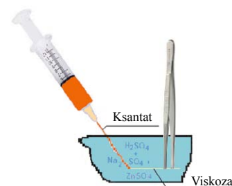
Sl.2 Shema ispredanja viskoznih vlakana postupkom mokrog ispredanja-istiskivanjem ksantata kroz hipodermalnu injekcijsku iglu u kupelj za ispredanja (koagulaciju)
