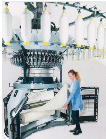
Sl.1 Kružnopletači jednoiglenični stroj model Spinit 3.0 E tvrtke Mayer & Cie. za proizvodnju glatkog kulirnog desno-lijevo pletiva sa sustavom dovoda pretpređa
