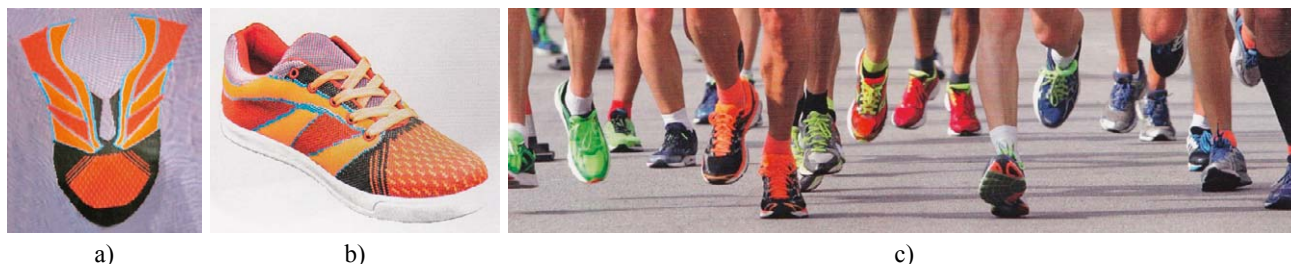
Sl.3 Pletiva za gornjišta obuće izrađena na kružnopletačem dvoigleničnom stroju model OVJA 1.1 EETT tvrtke Mayer & Cie.: a) uzorak kao jedinica raporta u metražnom pletivu jednog gornjišta, b) izrađeno gornjište na tenisici i c) različiti uzorci gornjišta na tenisicama za rekreacijsko trčanje
