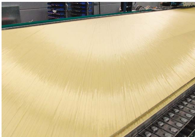
Sl.2 Biaksijalni aramidni tekstil površinske mase 180 g/m 2 na stroju COP MAX 5 Aramid prije učvršćivanja na mjestu pletenja
