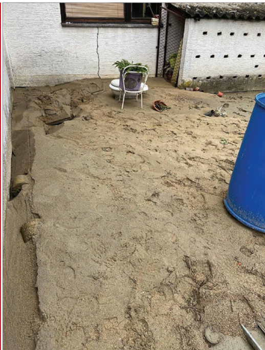
Sl. 9. Likvefakcija - pijesak koji je izišao na površinu zajedno s velikom količinom vode. Fotografija je snimljena u centru Siska, u dvorištu privatne kuće u blizini trgovačkog centra „Interspar“. foto: Tihomir Marjanović
