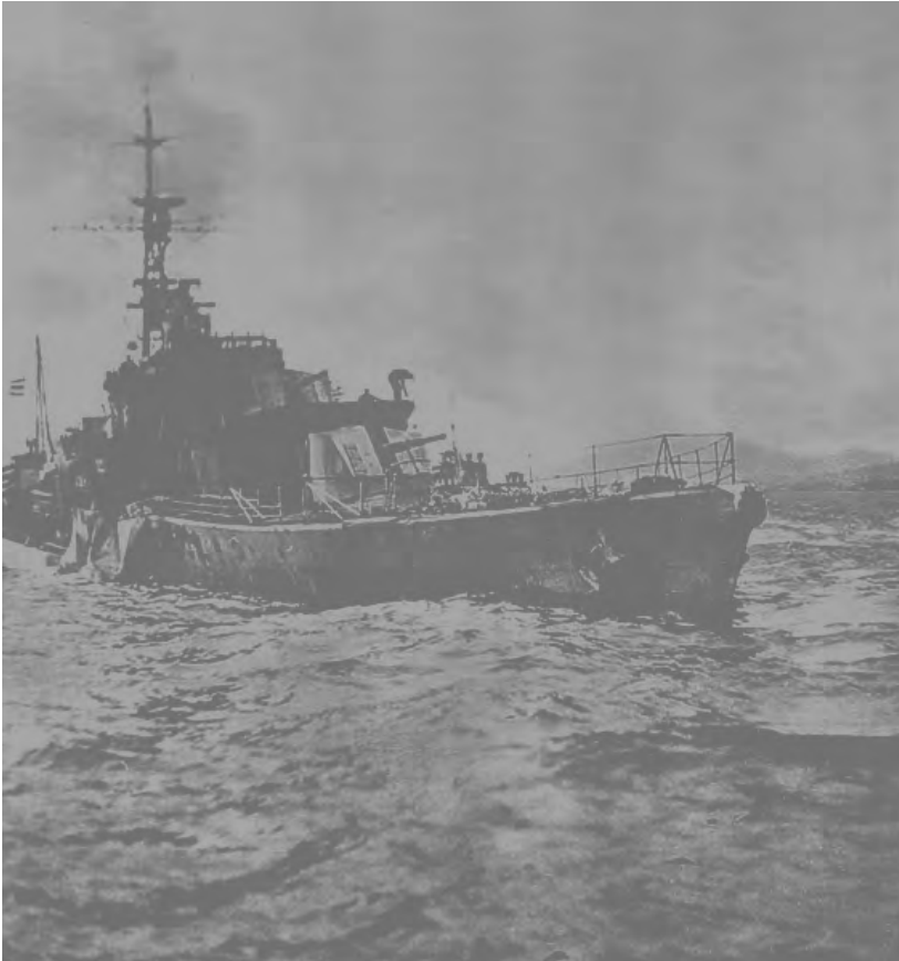
Il cacciatorpediniere HMS Saumarez dinanzi le coste albanesi, gravemente danneggiato dopo l'impatto con una mina il 22 ottobre 1946 nel canale di Corfù.
