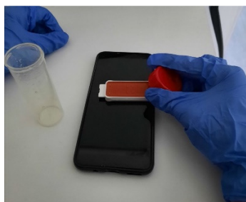
Slika 2 Uzorkovanje otiska s mobilnog uređaja
