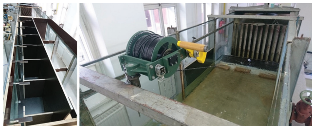
Slika 1. Stakleni žlijeb (kanal) u laboratoriju Zavoda za hidrotehniku (lijevo, pogled uzvodno) i zapornica na izlazu iz kanala (desno) [3]
