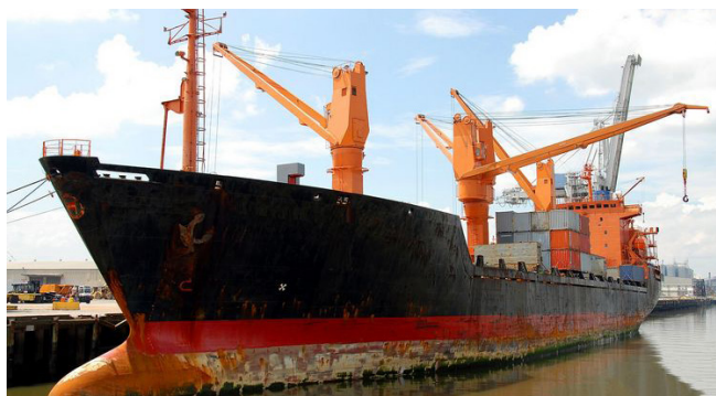
Slika 2 – Vodni trag – trošenja premaza uslijed obraštanja i korozije (Foto: Paul Brennan/Pixabay)
