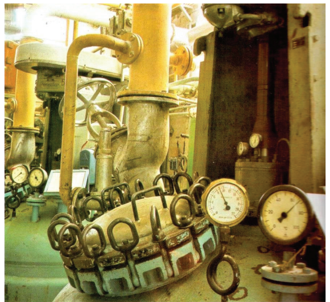
Slika 4 – Suspenzijska polimerizacija PVC-a (1973.) (izvor: Jugovinil, Monografija 1949. – 1974., Jugovinil, Kaštel Sućurac, 1974.; autor fotografije Željko Hell)
