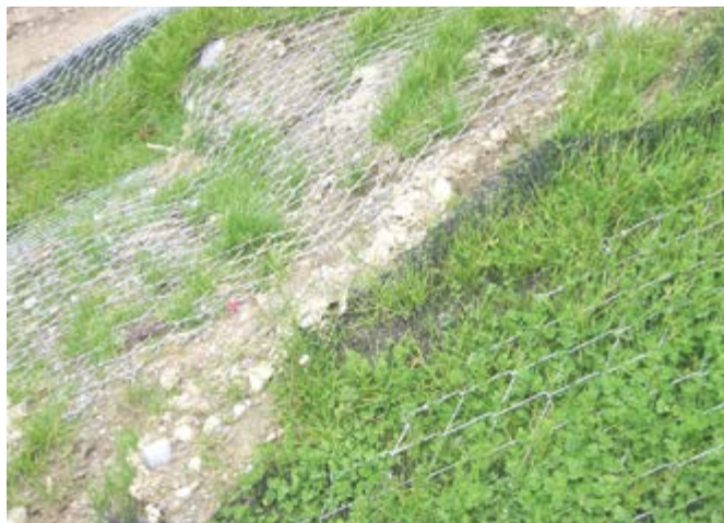
Slika 9. Testni poligon otprilike 10 tjedana nakon hidrosjette i obilne kiše. Na lijevoj strani slike nalazi se referentna površina bez geopletiva za zaštitu od erozije s manje od 10 posto ozelenjene površine. Na desnoj strani vidi se površina s geopletivom s više od 90 posto obnovljene vegetacije.
