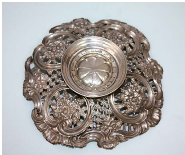
Prikaz 13. Zdjelica za voće izrađena od srebrnog lima (stražnja strana) – nakon elektrolitske redukcije
