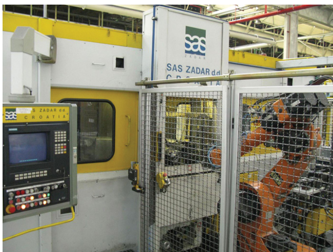
Slika 1 – Numerički upravljani rotacijski transforni stroj, SAS Zadar, 1995.
