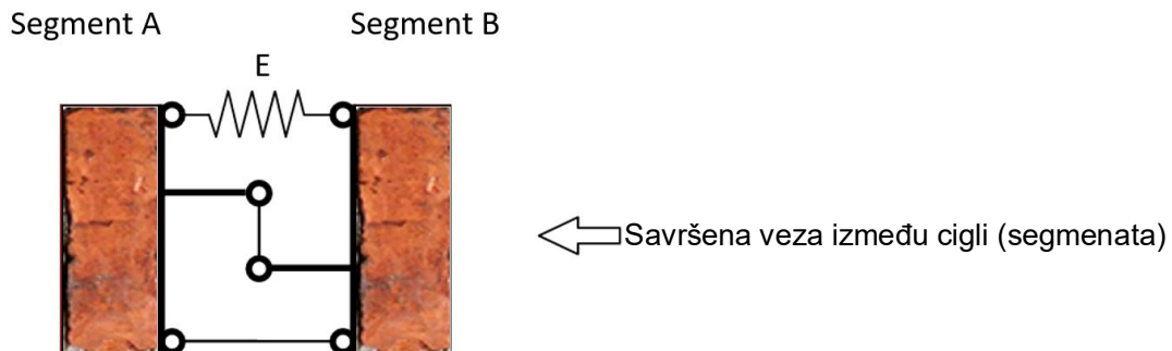
Slika 13. Predloženi model spoja (veze) između opeka (segmenata)
