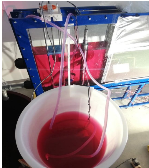
Slika 12. Kruženje slane vode pomoću dvije pumpe
