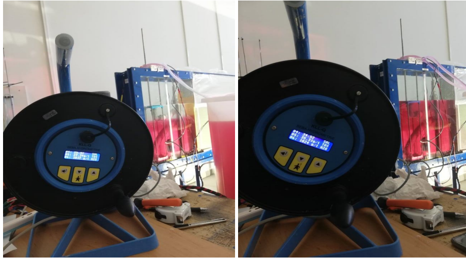
Slike 13. i 14. Dodavanje obojane slane vode u spremnik i računanje njenih parametara
