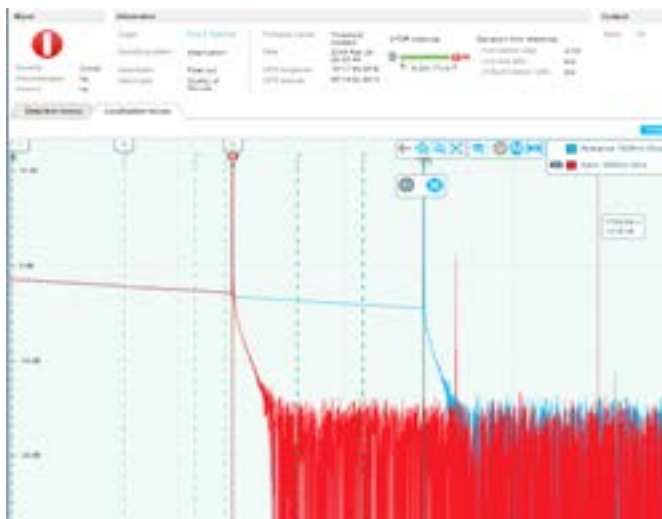
Slika 41. Lokalizacijska OTDR krivulja alarmnoga događaja
