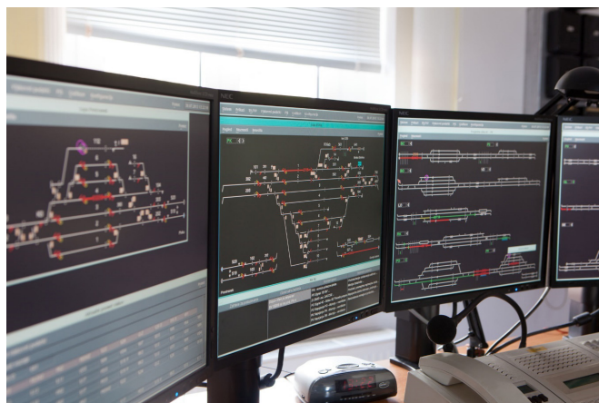
Slika 3. Centar središnjega upravljanja prometom – prikaz povećane slike pojedinih kolodvora sustava Iltis N na dvama lijevim zaslonima i pregledna slika cijele pružne dionice na desnome zaslonu
