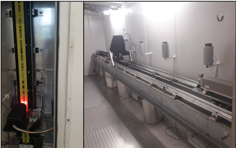
Slika 4. Vertikalni (lijevo) i horizontalni (desno) komparator na Tehničkom sveučilištu u Münchenu (Wasmeier i Foppe 2006).
