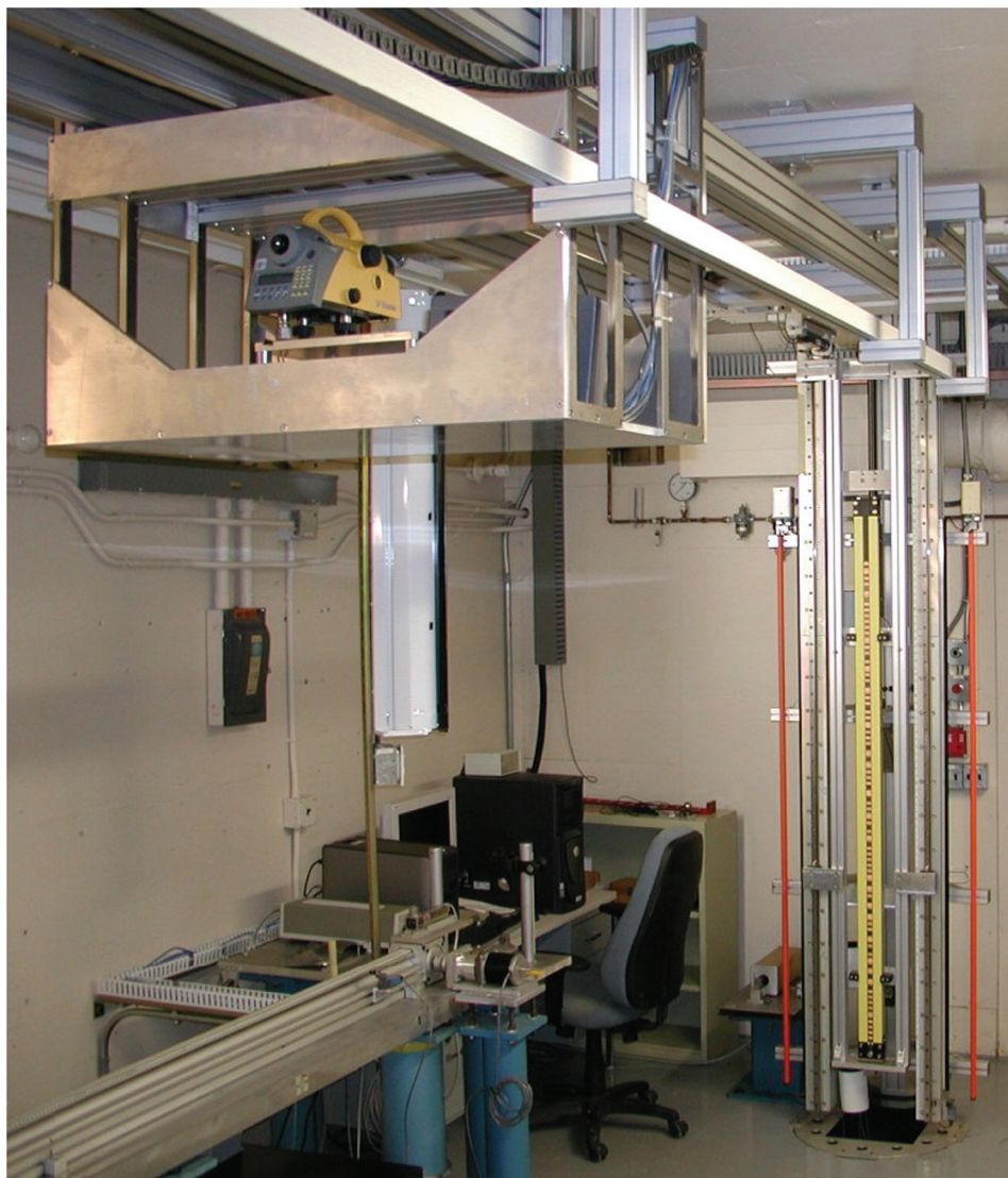
Slika 2. Vertikalni komparator na sveučilištu Stanford (Gassner i Ruland 2007).
