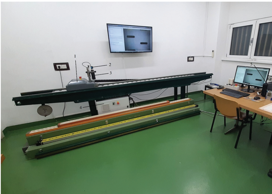
Slika 7. Komparator Geodetskog fakulteta s izmijenjenim dijelovima (1 – kolica sa servomotorom, 2 – kamera sa CCD senzorom, 3 – telecentrični objektiv, 4 – upravljačko računalo, 5 – serversko računalo).
