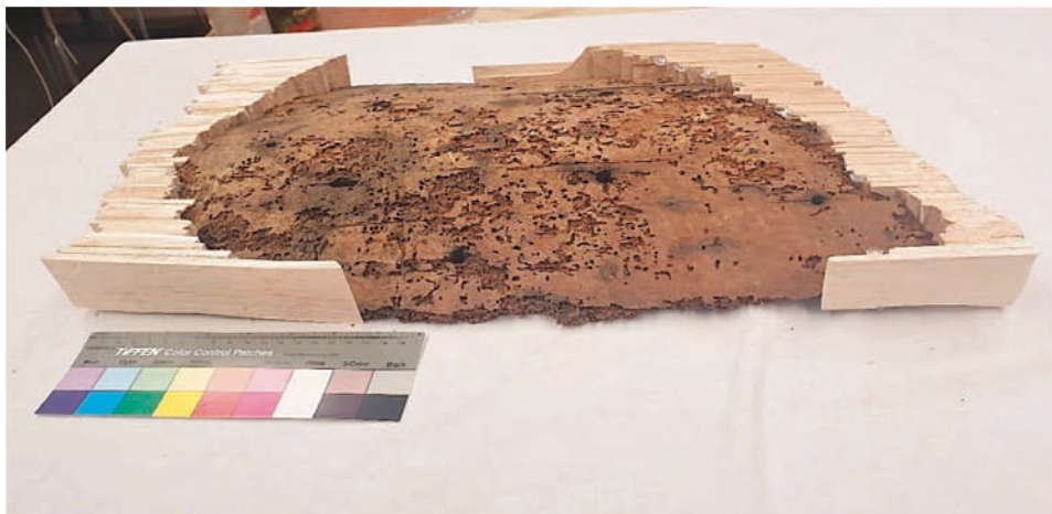
Slika 30. Rekonstrukcija štapićima drva balse (foto: J. Bogdanović)
