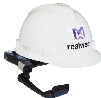
Slika 1 – RealWear HMT-1 je nosivo Android tablet-računalo predviđeno za upotrebu bez ruku za radnike u industriji. Može se upotrebljavati u mokrim, prašnjavim, vrućim, opasnim i glasnim industrijskim okruženjima. Robusni uređaj montiran na glavu po želji se uklapa u zaštitne kacige ili pričvršćuje na kape te se može upotrebljavati i sa zaštitnim naočalama (izvor: https://realwear.com/ ).
