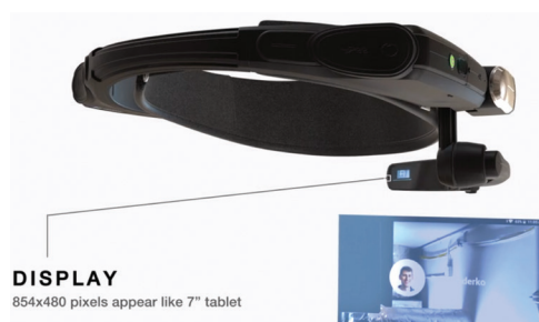
Slika 2 – Mikro zaslon visoke razlučivosti nalazi se tik ispod vidokrugla i prikazuje sliku poput tableta dijagonale 7 inča. Zahvaljujući 4 digitalna mikrofona i naprednim algoritimima, softver za prepoznavanje glasa može raditi s industrijskim pozadinskim zvukovima od oko 95 dB. HMT-1 radi s moćnim softverskim aplikacijama uz potpuno glasovno upravljanje bez upotrebe ruku. Upotrebljava se za video-pozive i daljinsko mentorstvo, navigaciju dokumentima, vođeni tijek rada i industrijsku IoT vizualizaciju podataka (izvor: https://realwear.com/ ).
