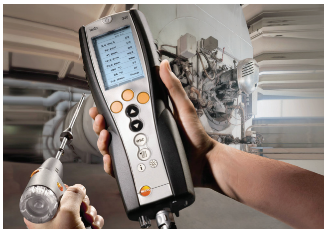
Slika 4 – Testo 340 – analizator izgaranja za komercijalne i industrijske primjene. Može izmjeriti \text{CO} , \text{NO} , \text{NO}_2 ili \text{SO}_2 (izvor: https://www.testo.com/ ).
