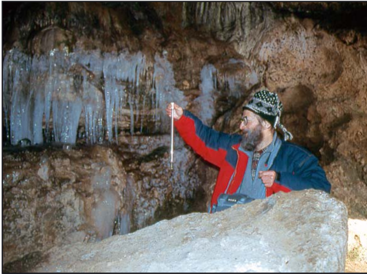
Mjerenje temperature zraka pomoću preciznog živinog termometra foto: V. Božić
