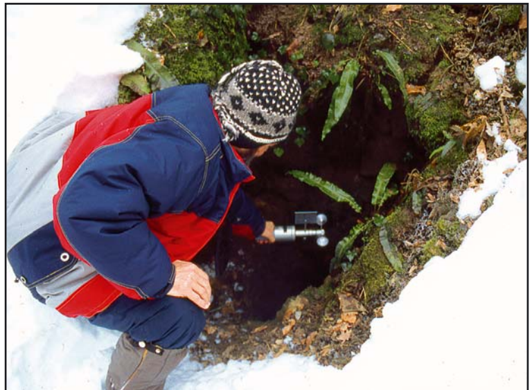
Mjerenja brzine strujanja zraka na ulazu u Dvogači foto: V. Božić
