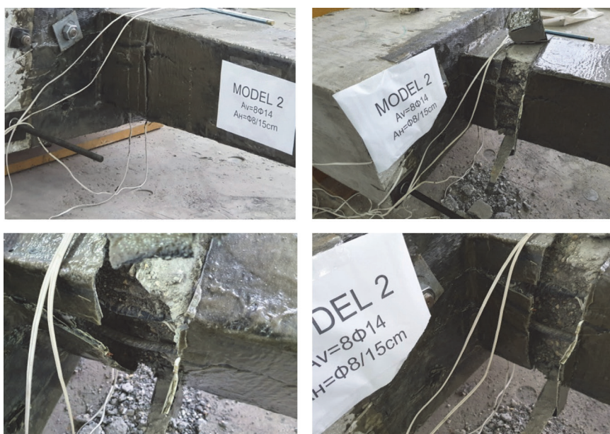
Slika 18. Fotografije snimljene tijekom kvazistatičkih ispitivanja na modelu stupa – Model M2
