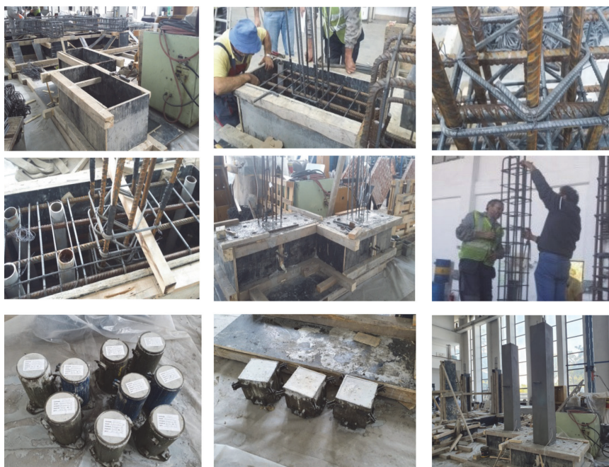
Slika 3. Izrada modela stupova (model M1 i model M2) za eksperimentalna ispitivanja
