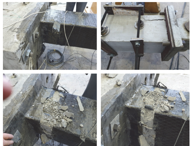
Slika 13. Fotografije snimljene tijekom kvazistatičkog ispitivanja modela stupa – modela M1
