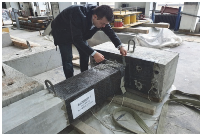
Slika 14. Fotografije snimljene tijekom kvazistatičkog ispitivanja modela stupa – modela M1
