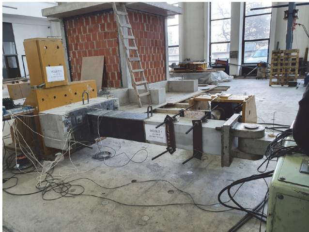
Slika 6. Raspored elemenata modela stupova i opreme tijekom eksperimenta
