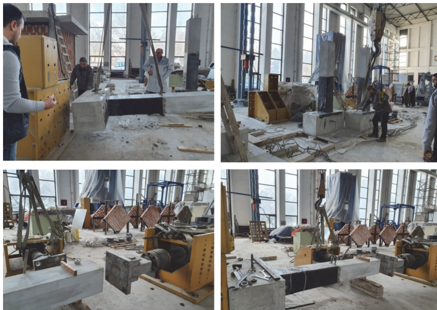
Slika 9. Montaža oslonaca i modela u laboratoriju UKIM-IZIIS-a
