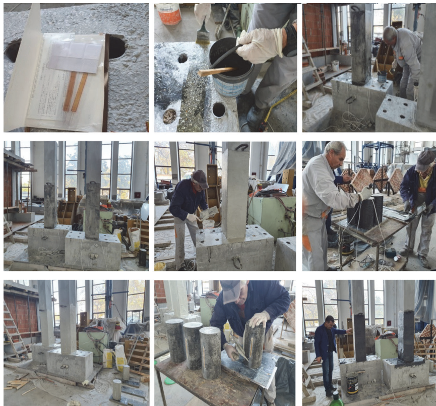
Slika 5. Fotografije snimljene tijekom nanošenja CFRP-a na modele i betonske valjke
