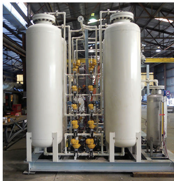
Slika 4 – Sustav za adsorpciju pod promjenjivim tlakom (engl. Pressure Swing Adsorption , PSA) se primjenjuje za oporabu i pročišćavanje vodika iz raznih struja bogatih vodikom. Tehnologija se oslanja na razlike u adsorpcijskim svojstvima plinova da bi ih se razdvojilo pod tlakom i učinkovit je način proizvodnje vrlo čistog vodika.
