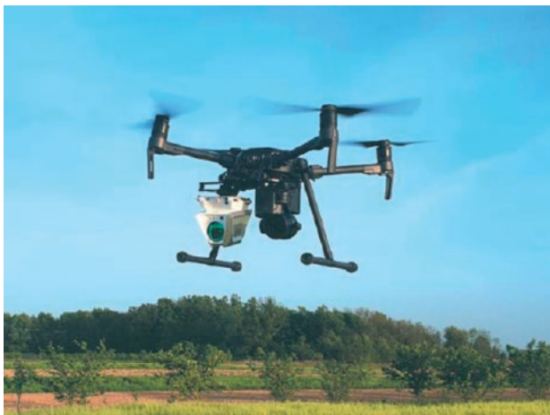
Slika 19. Беспилотна летјелјца опремљена видеокamerom i TDLAS detektorom metana
