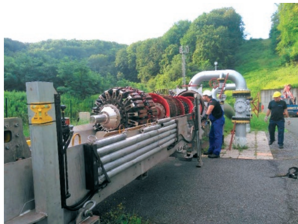
Slika 7. Korišteni MFL alat na plinovodu promjera DN800
