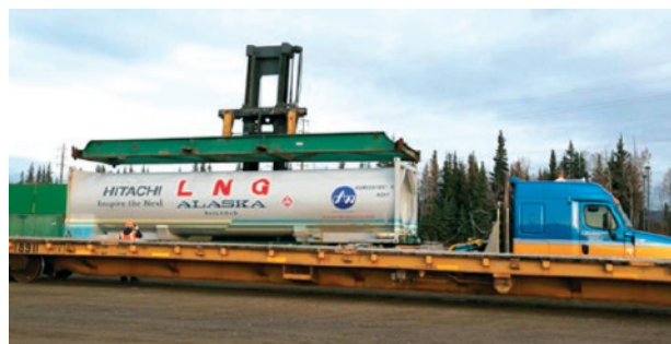
Slika 8. Intermodalni prijevoz UPP-a – pretovar transportne jedinice UPP-a na željeznicu Izvor: Natural Gas World , objavljeno ožujak 2019.
