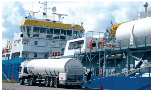
Slika 7. Opskrba UPP cisternom broda pogonjenog UPP-om Izvor: Gasum, objavljeno u Baltic Transport Journal , travanj 2020.
