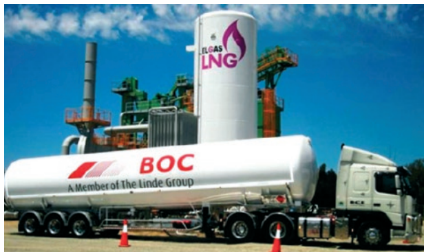
Slika 6. Opskrba UPP cisternom satelitske UPP stanice Izvor: Elgas LNG, objavljeno u Natural Gas World , ožujak 2019.
