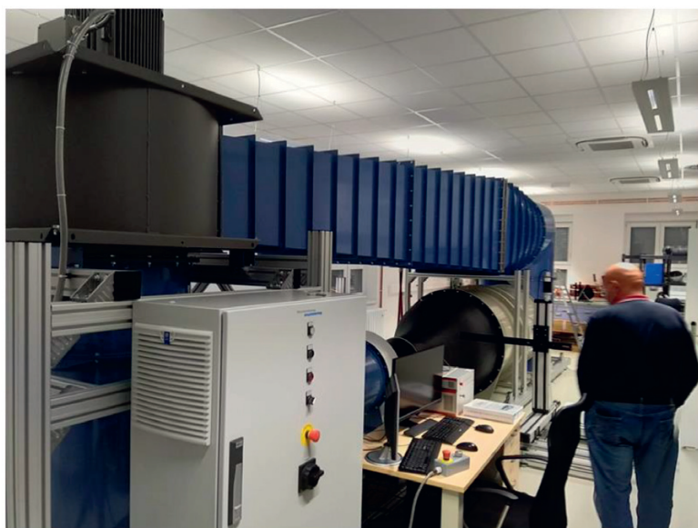
Slika 2. Instalirani wind tunel za umjeravanje osjetnika brzine i smjera vjetra.
