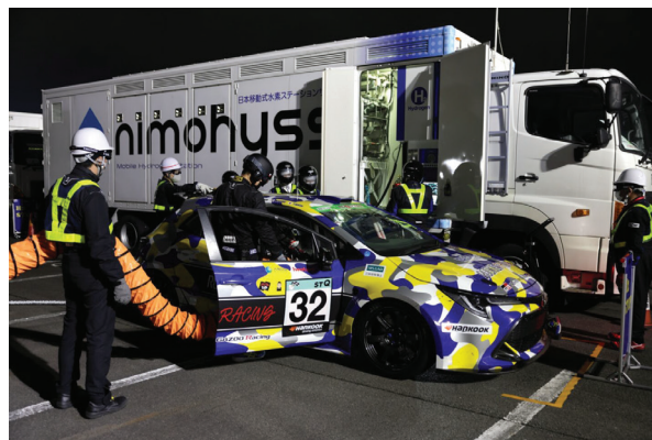
Slika 2 – Toyotin trkači prototip pogonjen motorom s unutarnjim sagorijevanjem vodika na stazi Fuji Speedway u Japanu (lijevo), nadopunjavanje prototipa stlačenim vodikom (desno)
