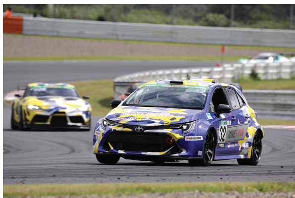
Slika 2 – Toyotin trkači prototip pogonjen motorom s unutarnjim sagorijevanjem vodika na stazi Fuji Speedway u Japanu (lijevo), nadopunjavanje prototipa stlačenim vodikom (desno)
