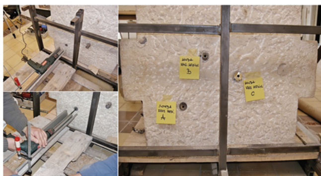
Slika 9. Sondiranje mesinganih trnova bušenjem
