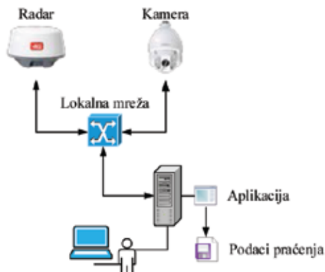
SI 7: Ilustracija sustava za demonstraciju praćenja cilja radarski male refleksijske površine.
