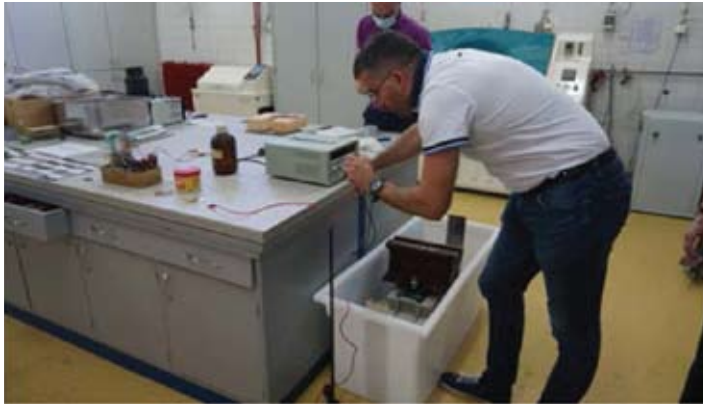
SI 9. Provedba ispitivanja utjecaja lutajućih struja na sustav pričvršćenja tračnica
