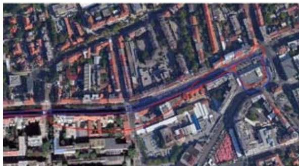
SI 5: Putanja tramvaja prilikom zaokreta oko Kvaternikovog trga. Crvena putanja prikazuje rezultat iz IMU i GPS uređaja, dok je plava rezultat algoritma fuzije s vizualno inercijalnom odometrijom
