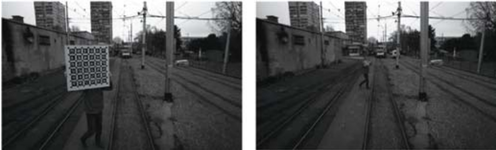
SI 4: Primjer umjeravanja kamera (lijevo) te radara i kamere
