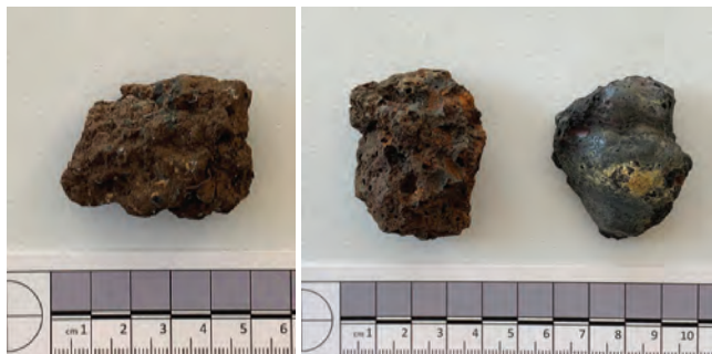
Sl. 17 a, b Otpaci prerade željeza (šljaka) (fotografija: K. Buršić-Matijašić, 29. 3. 2021.).
